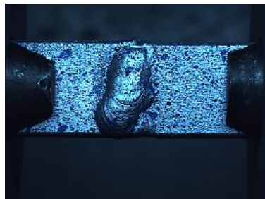
Figura 6. Imagen obtenida mediante una cámara web que registra la deformación de la probeta soldada.
