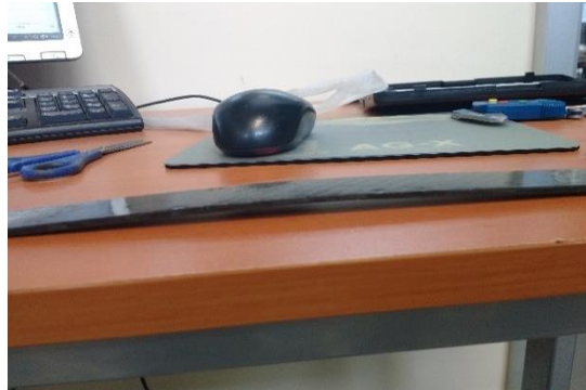
Imagen 5.- Probeta de tres capas al finalizar el ensayo de flexión
