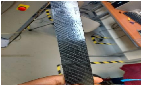
Fig 6.- Se observa las pequeñas fracturas sobre la superficie de la probeta de fibra de carbono.
