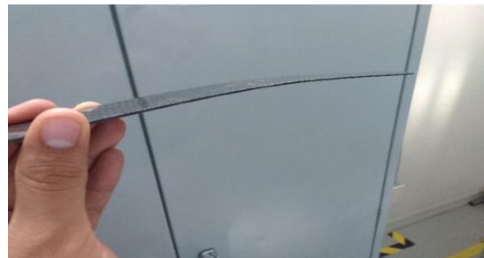
Fig 7.- Mismo efecto de fluencia al momento de retirar la probeta.
