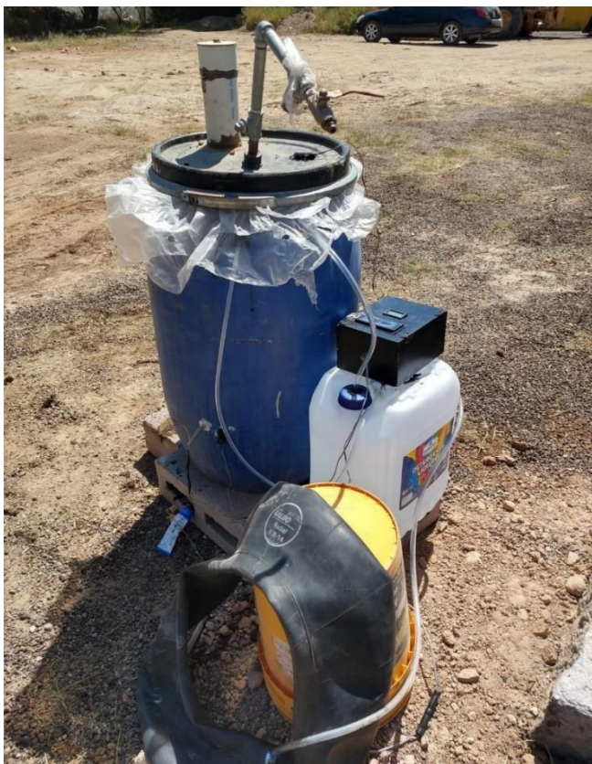
Figura 1. Sistema de biodigestión empleado: se observa el contenedor biodigestor, la trampa de agua, el receptor de gas y la caja de control del sistema embebido.
