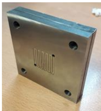
Figura 3. Maquinado del diseño serpentin en acero 1018
