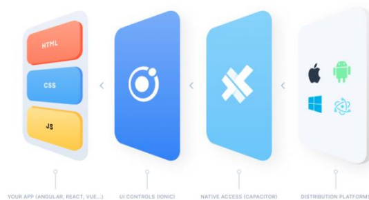
Figura 1. Este cuadro ejemplifica cómo Capacitor facilita la exposición de la funcionalidad nativa a la aplicación web en forma de multiplataforma.[2]
