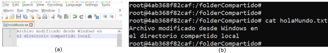
Figura 6. Comprobando modificación. (a) En Windows se modifica el archivo con algún editor de texto. (b) Dentro del contenedor, el contenido del archivo puede visualizarse con cat.
