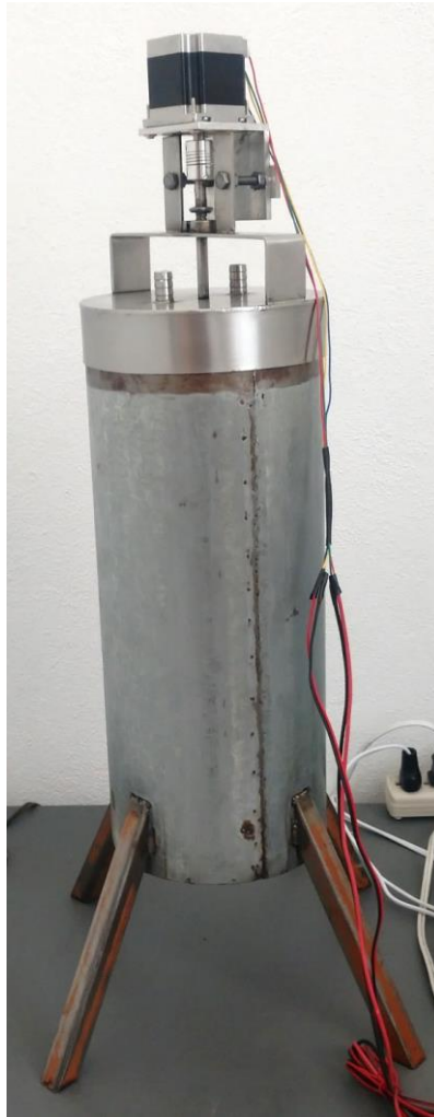
Figura 5. Reactor construido completo en vista completa. Se observa la carcasa y el sistema de agitación integrado.
