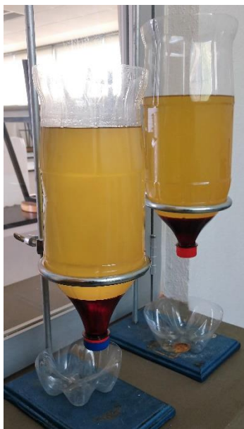
Figura 14. Productos resultantes de la operación del reactor con reacciones transesterificación: experimento 1 y 3 del arreglo ortogonal 3.
