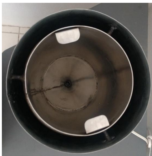
Figura 9. Vista superior interna del reactor. Se aprecia el tanque montado dentro de la carcasa.
