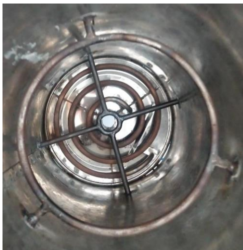
Figura 7. Acercamiento de la vista interna de la carcasa. Se visualiza al fondo la resistencia eléctrica.
