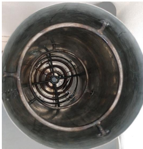
Figura 6. Vista interna de la carcasa. Se muestran los anillos de soporte del tanque.
