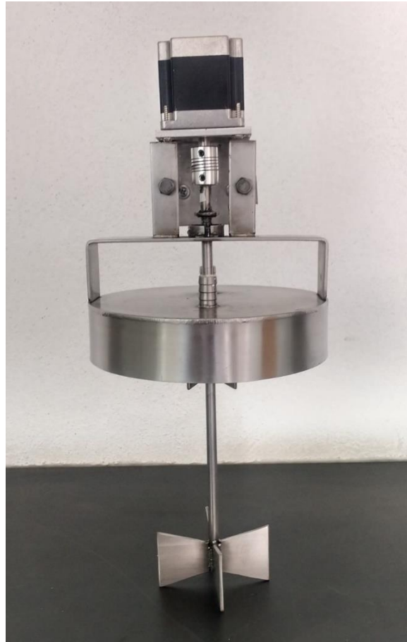
Figura 10. Vista completa del sistema de agitación. Se presenta el agitador propulsor, el motor, tapa cilíndrica.
