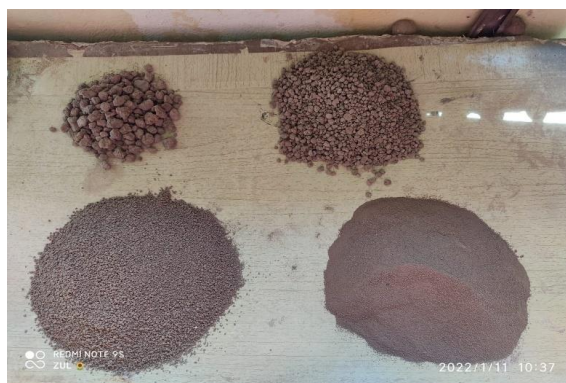
Figura 16. Test tacto visual, muestra FC. Fuente: Elaboración propia, 2022.
