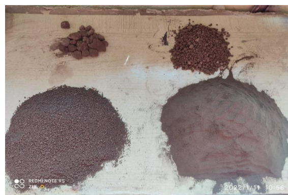
Figura 17. Test tacto visual, muestra FZ. Fuente: Elaboración propia, 2022.
