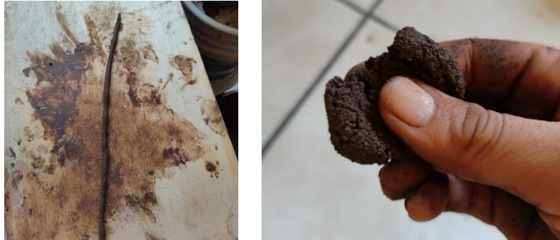
Figura 8: Ejemplo del resultado del test del cordón. Fuente: Elaboración propia, 2022.
