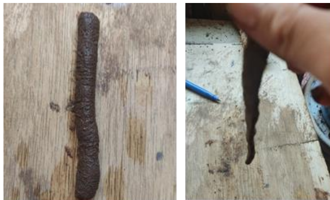
Figura 9: Ejemplo del resultado del test de la cinta de barro Fuente: Elaboración propia, 2022.
