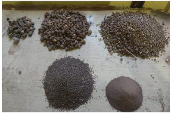
Figura 11: Test tacto visual, muestra CC1. Fuente; Elaboración propia, 2022.
