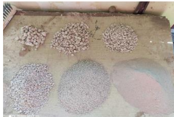
Figura 12: Test tacto visual, muestra CC2. Fuente: Elaboración propia, 2022.
