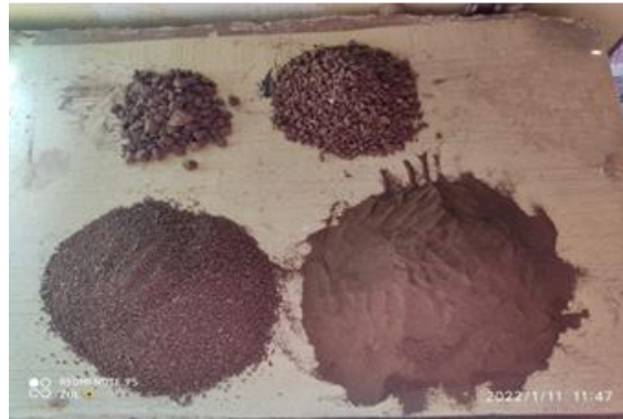
Figura 14: Test tacto visual, muestra ARM. Fuente: Elaboración propia, 2022.
