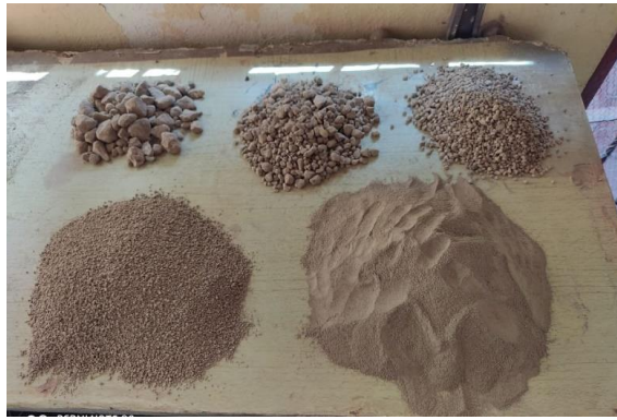
Figura 18. Test tacto visual, muestra CUH. Fuente: Elaboración propia, 2022.
