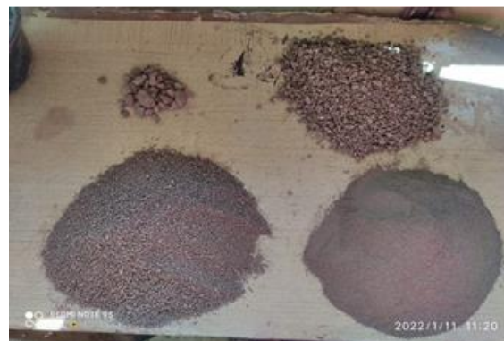
Figura 13: Test tacto visual, muestra MZA. Fuente: Elaboración propia, 2022.
