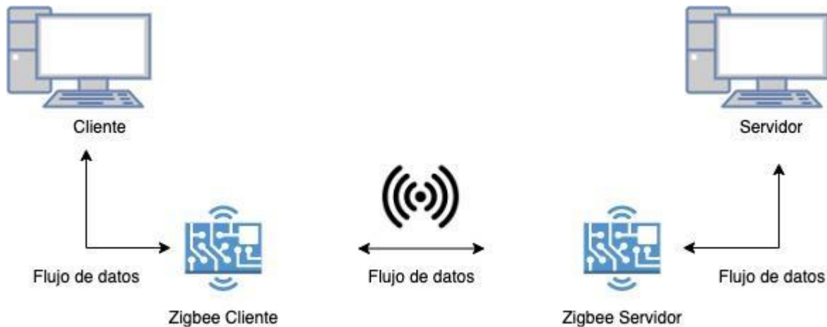
Figura 3. Descripción gráfica de las conexiones en el experimento ZigBee.
