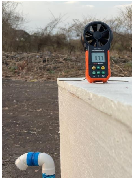
Figura 13. Medición de la velocidad de los vientos con el anemómetro dual digital. Fuente, elaboración propia,2022.
