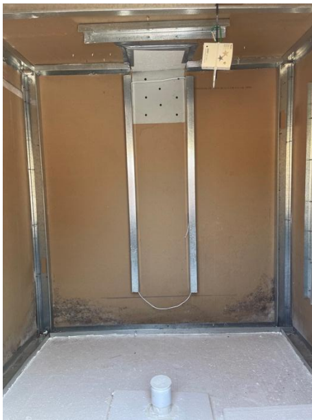
Figura 11. Colocación de Hobo dentro de los módulos. Fuente, elaboración propia, 2022.
