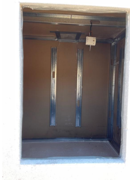
Figura 11. Colocación de Hobo dentro de los módulos. Fuente, elaboración propia, 2022.
