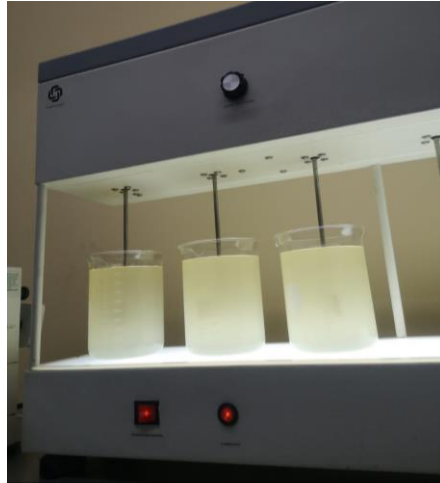
Figura 2. Prueba de jarras para la coagulación-floculación
