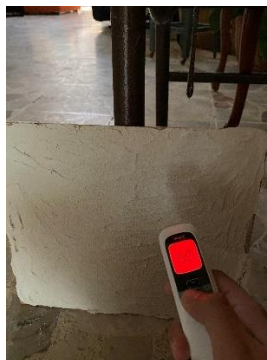
Figura 20. Temperatura en lecho frontal a 10 cm con 250°C. Fotografía propia.
