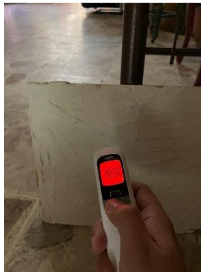
Figura 22. Temperatura en lecho frontal a 20 cm con 150°C. Fotografía propia.
