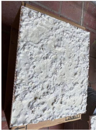
Figura 3. Aplicación de la mezcla estuco – plástico sobre la madera MDF. Fotografía propia.
