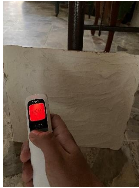
Figura 21. Temperatura en lecho posterior a 10 cm con 250°C. Fotografía propia.
