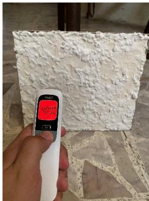
Figura 16. Temperatura en lecho posterior a 20 cm con 250°C. Fotografía propia.
