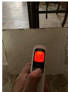
Figura 25. Temperatura en lecho posterior a 20 cm con 250°C. Fotografía propia.
