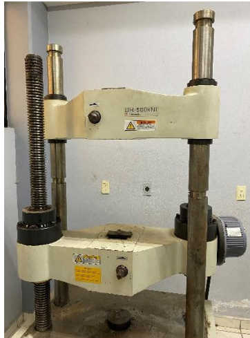
Figura 26. Modelo de la máquina de ensayos Shimadzu UH-500Kni. Fotografía propia.
