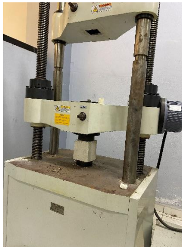
Figura 27. Muestra de estuco – plástico dentro de la maquina universal de ensayos. Fotografía propia.
