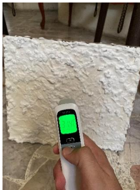
Figura 14. Temperatura en lecho posterior a 20 cm con 150°C. Fotografía propia.
