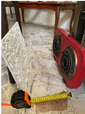
Figura 12. Toma de la distancia para la prueba a 20 cm para 150°C y 250°C. Fotografía propia.
