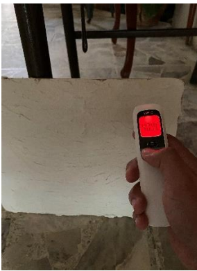
Figura 18. Temperatura en lecho frontal a 10 cm con 150°C. Fotografía propia.
