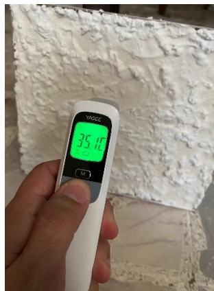
Figura 9. Temperatura en lecho posterior a 10 cm con 150°C. Fotografía propia.
