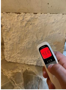
Figura 11. Temperatura en lecho posterior a 10 cm con 250°C. Fotografía propia.
