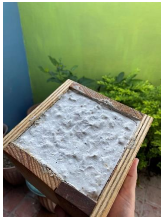
Figura 5. Mezcla de estuco – plástico moldeado. Fotografía propia.
