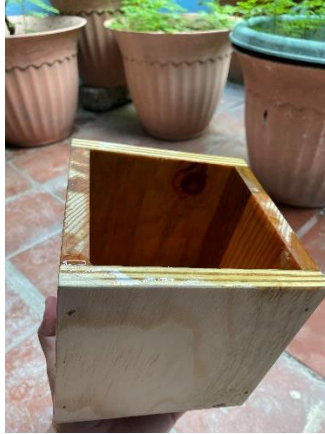
Figura 4. Molde de la muestra para ensayo a compresión. Fotografía propia.
