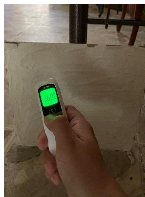
Figura 23. Temperatura en lecho posterior a 20 cm con 150°C. Fotografía propia.
