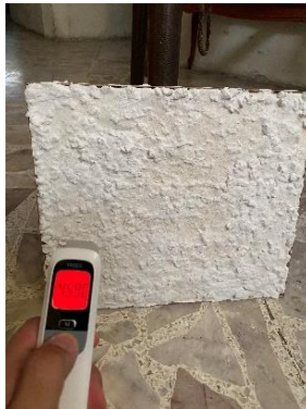
Figura 15. Temperatura en lecho frontal a 20 cm con 250°C. Fotografía propia.
