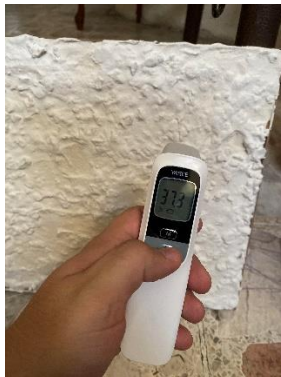
Figura 13. Temperatura en lecho frontal a 20 cm con 150°C. Fotografía propia.
