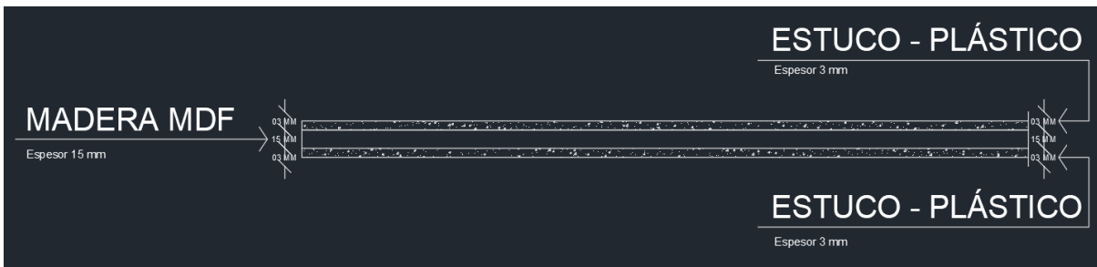
Figura 1. Diagrama de la muestra. Elaboración por medio del software Autocad Autodesk.
