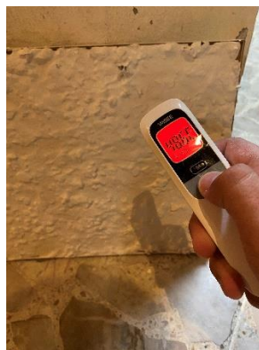
Figura 10. Temperatura en lecho frontal a 10 cm con 250°C. Fotografía propia.
