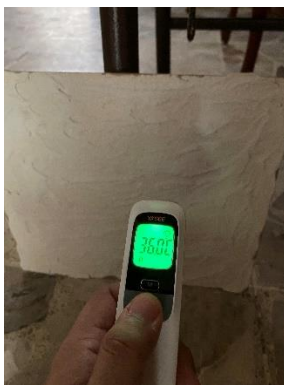
Figura 19. Temperatura en lecho posterior a 10 cm con 150°C. Fotografía propia.
