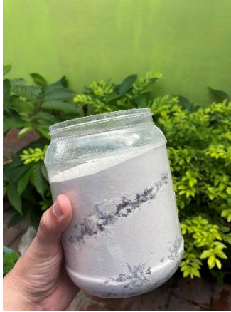
Figura 2. Muestra en seco de la mezcla estuco – plástico. Fotografía propia.
