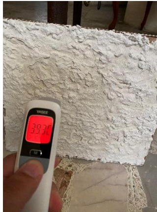
Figura 8. Temperatura en lecho frontal a 10 cm con 150°C. Fotografía propia.
