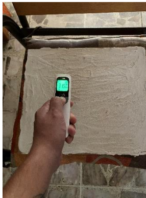
Figura 17. Temperatura base de muestra con estuco. Fotografía propia.
