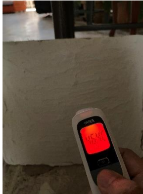
Figura 24. Temperatura en lecho frontal a 20 cm con 250°C. Fotografía propia.
