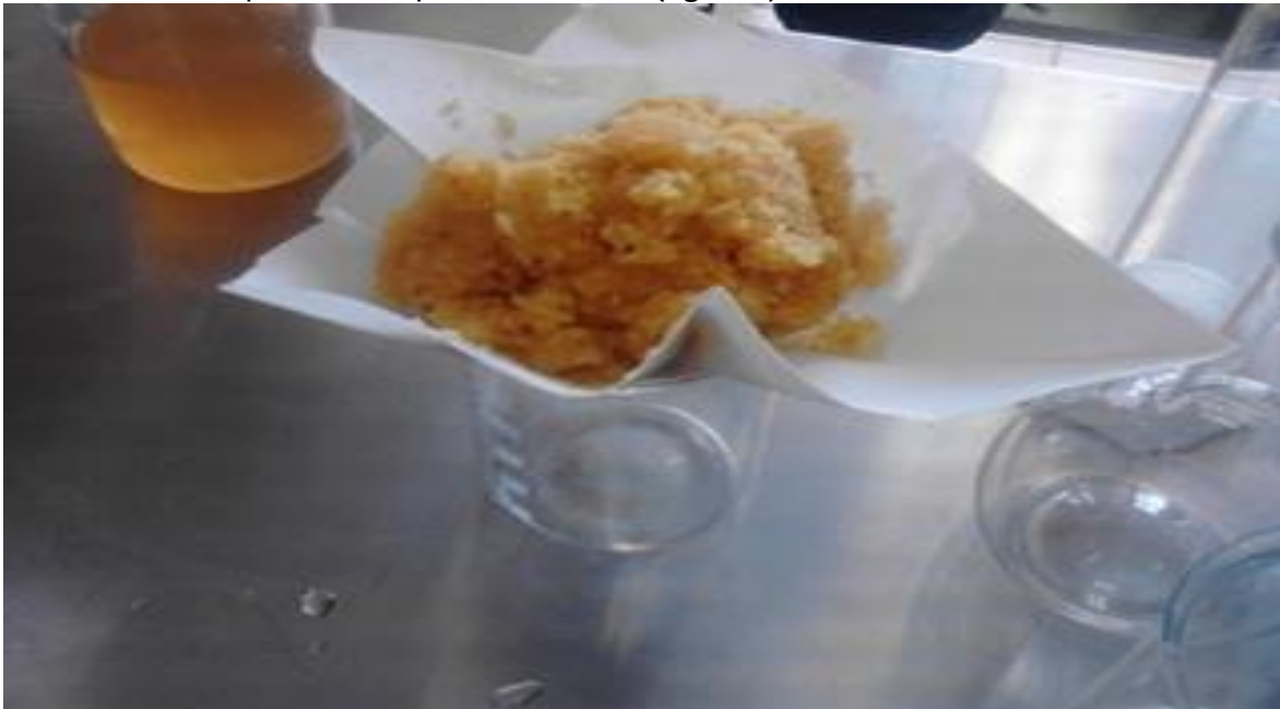
Figura 5. Blanqueado de pasta de celulosa
