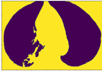
Figura 3. TC torácica segmentada con Thresh otsu OpenCV, donde nuestra área de interés son los pulmones. [fuente propia]
