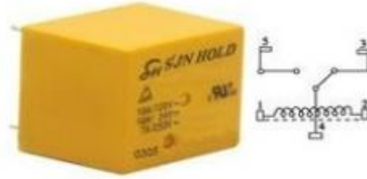
Figura 11. Componentes del Relé.
