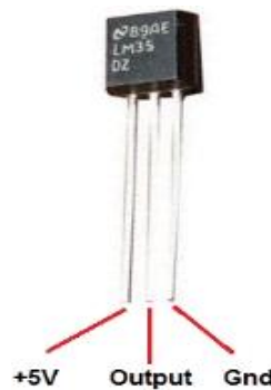
Figura 5. Componentes del sensor LM35.
