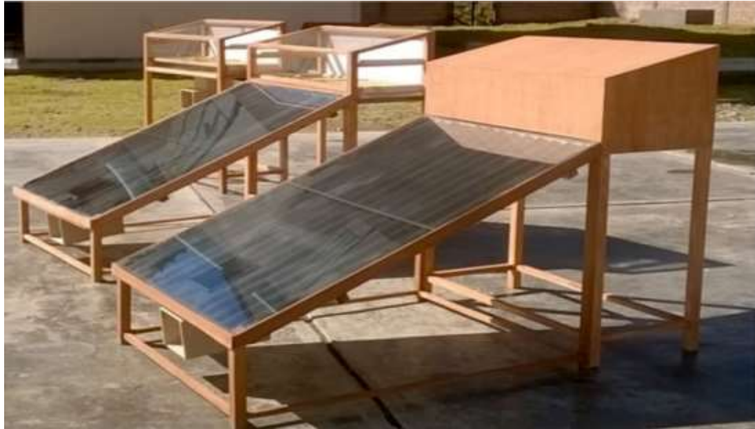
Figura 6. Secador solar directo, mixto e indirecto (ordenados de izquierda a derecha)
