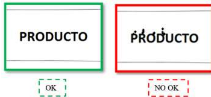
Figura 30. Esquema para validar tampografía sin tinta corrida Fuente: Elaboración propia con base en la experiencia en el proceso productivo
