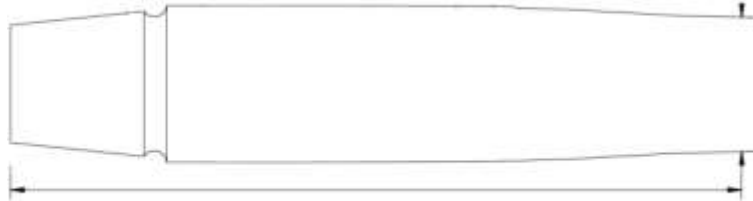
Figura 7. Esquema de medición de longitud de inicio de zona de ensamble a base del mango de madera
