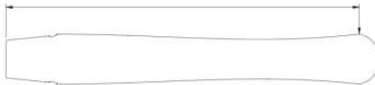
Figura 10. Esquema de medición del diámetro de la base del mango Fuente: Elaboración propia con base en la experiencia en el proceso productivo
