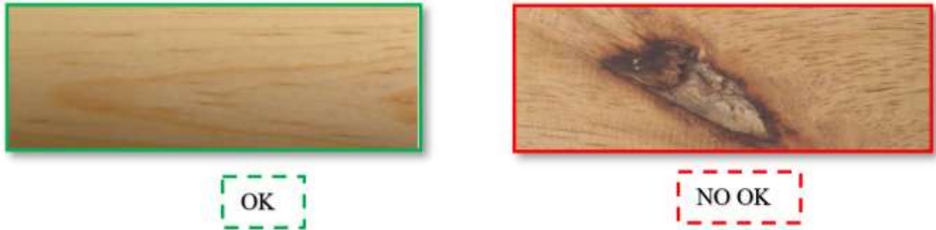
Figura 20. Esquema para validar madera libre de nudos Fuente: Elaboración propia con base en la experiencia en el proceso productivo
