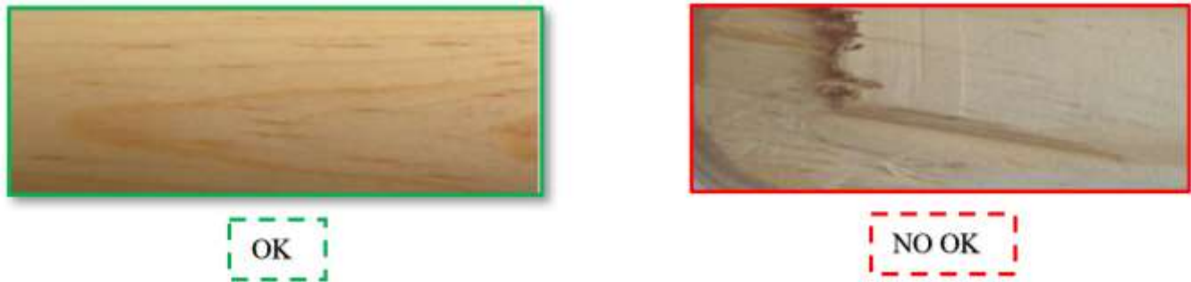
Figura 22. Esquema para validar madera libre de desgarres
