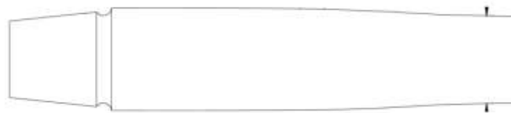
Figura 8. Esquema de medición del diámetro en cuerpo
