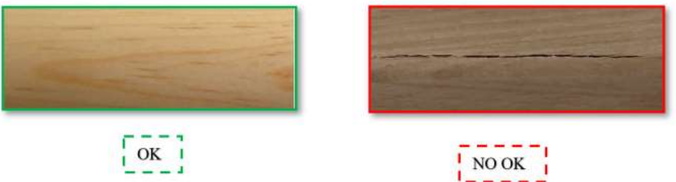
Figura 19. Esquema para validar madera libre de fisuras
