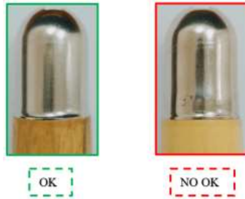
Figura 33: Esquema para validar que el casquillo no presente desprendimiento de cromo Fuente: Elaboración propia con base en la experiencia en el proceso productivo
