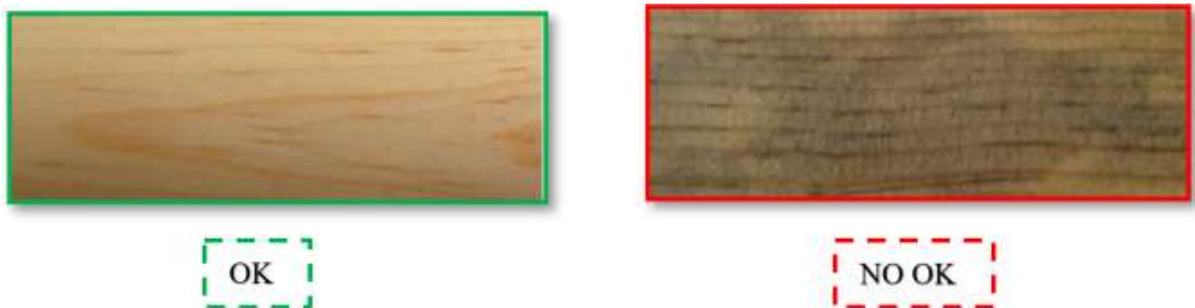
Figura 21. Esquema para validar madera libre de manchas de hongo Fuente: Elaboración propia con base en la experiencia en el proceso productivo
