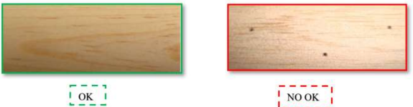
Figura 18. Esquema para validar madera libre de picaduras
