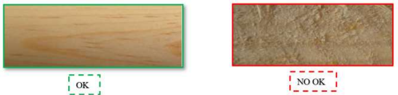
Figura 23. Esquema para validar madera libre de asperezas
