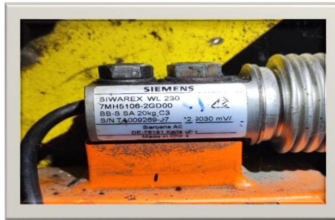
Figura 3. Celda de carga instalada
