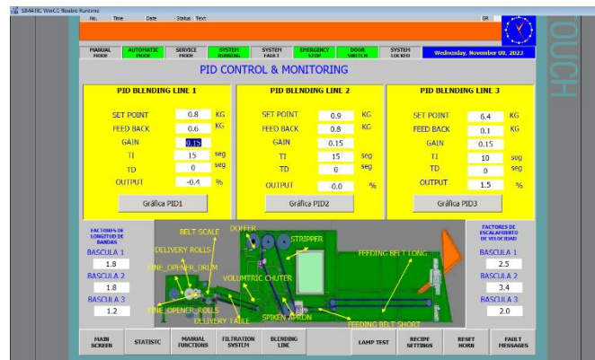
Figura 12. Pantalla que se diseñó de ajuste PID
