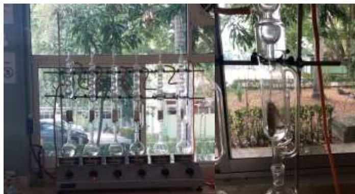
Imagen 2. Equipo de calentamiento para Soxleth con 6 mantillas, para la extracción del diesel de la muestra de suelo
