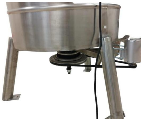
Figura 13. Montaje de motor
