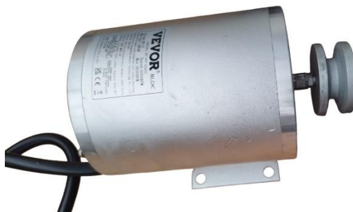
Figura 12. Montaje de polea
