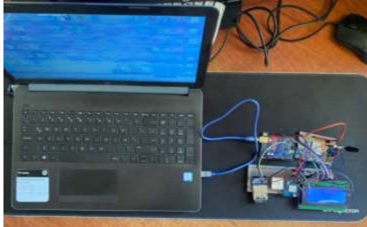
Figura 18. Circuito transmisor de datos energizado a través de Laptop
