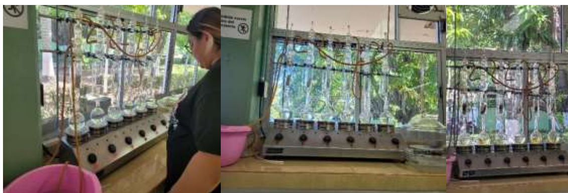
Imagen 3. Determinación de diésel con el equipo Soxhlet
