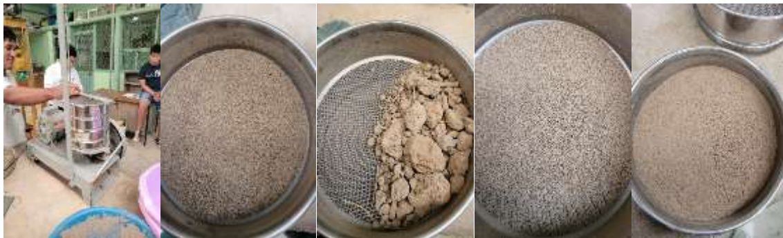
Imagen 2. Tamizado de las muestras de suelo contaminado después del lavado
