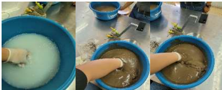
Imagen 1. Lavado del suelo contaminado
