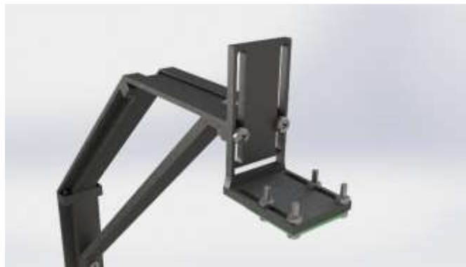
Figura 8. Ajustes del soporte de la cámara
